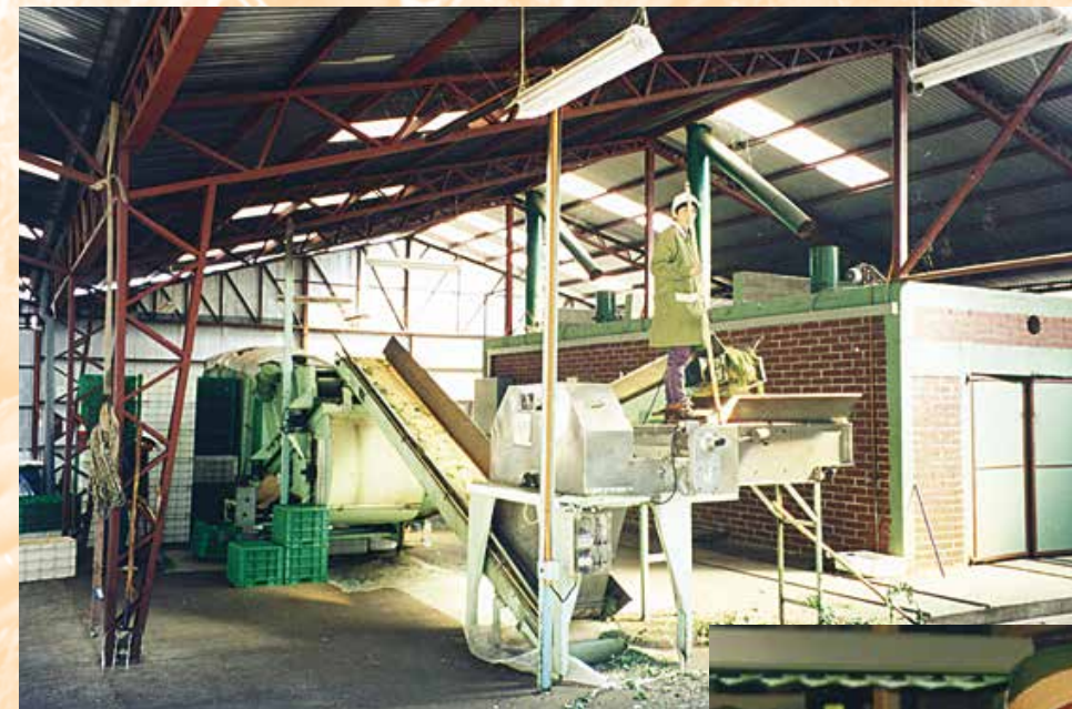
Separación de hojas y tallos y secadero de rejilla.
