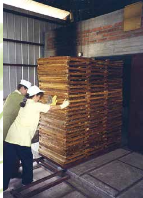
Operación de carga del secadero de rejilla.
